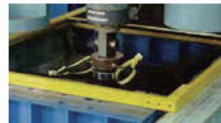
金網中央部の破壊点：2520N 横フレームの破壊点：8680N
